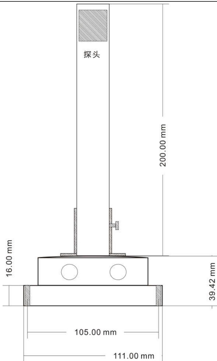
如下图所示，为法兰的安装示意图，客户将法兰固定住后使用法兰柱上的螺丝固定住传感器即可。
